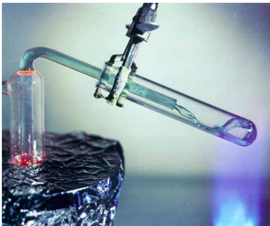
FIGURA 3. Sales fluoradas de litio y berilio (FLiBe) fundidas. Oak Ridge National Laboratory.
